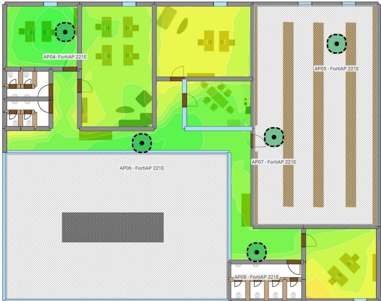
**Intensidad de la señal para el edificio de oficinas OG en la banda de 5 GHz**
